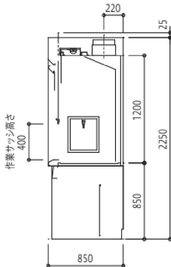
【配管立上り位置】 据付天井高 >2400mm
