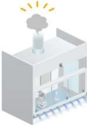
VAV制御では、作業内容に合わせた環境を構築することが要求されます。サッシが開いているときはその開度に合せて面風速が一定となるように風量がコントロールされます。一方、サッシが閉まった状態ではフード内の換気回数も考慮して、必要最低限の風量となるように制御されます。
